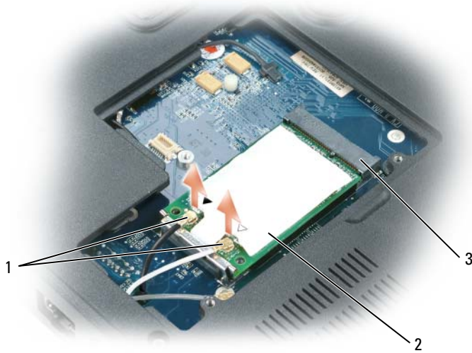
1 Antennenkabel (2) 2 Mini-Card 3 Mini-Card-Anschluss
